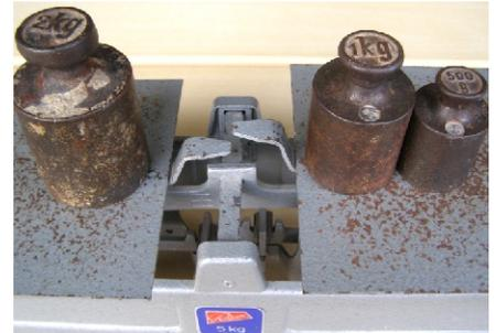
Die Waage ist im Gleichgewicht, weil auf beiden Seiten das gleiche Gewicht ist.
